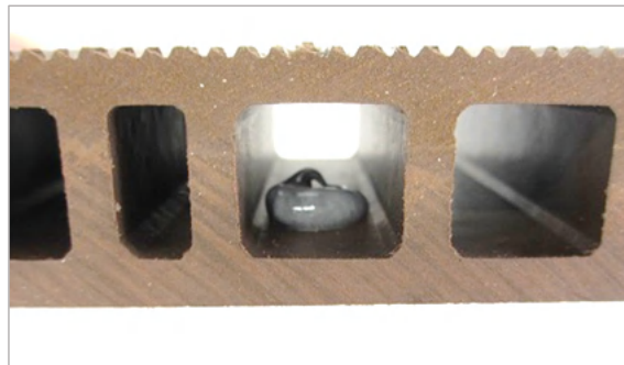
④接着剤を中空底面に充填する
