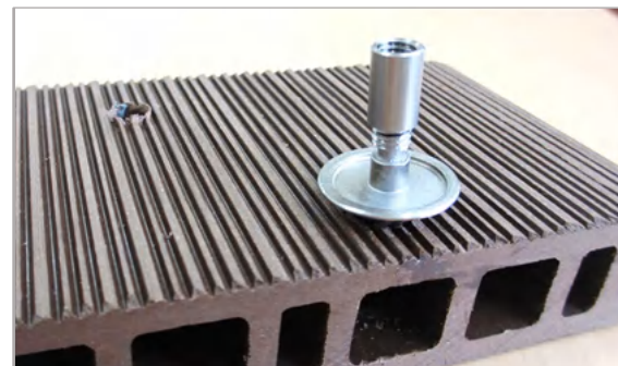
⑤鋏の足に接着剤を塗布しジョイントナットを連結する(ジョイントナットで点字鋏の足の長さを調整する)
