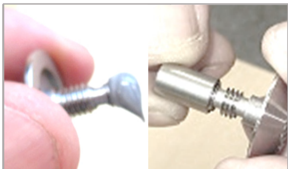
⑤鋏の足に接着剤を塗布しジョイントナットを連結する(ジョイントナットで点字鋏の足の長さを調整する)
